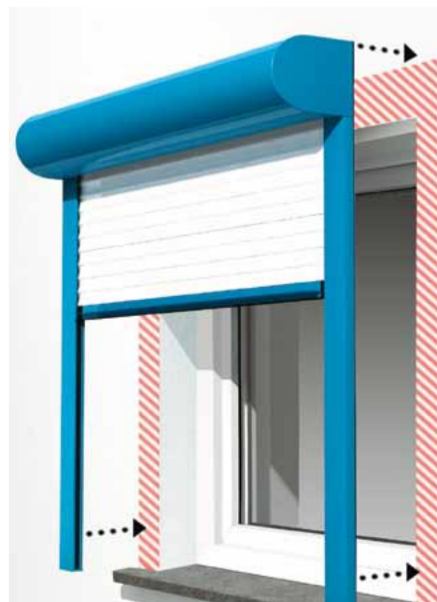
Einfache und saubere Montage, wahlweise in der Laibung oder auf dem Mauerwerk.
